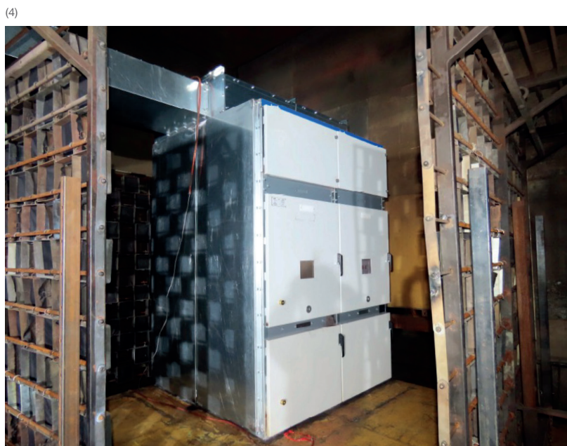
(4) Quadro con condotto gas prima del test all'arco interno (4) Switchboard with gas duct before internal arc proof test (4) Tableau avec conduit du gaz avant essai à l'arc intérieur (4) Cuadro con conducto gas antes de la prueba de tenuta al arco interior
