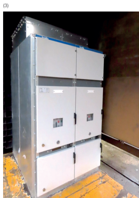
(3) Quadro con filtro spegniarco prima del test all'arco interno (3) Switchboard with top chimney before internal arc proof test (3) Tableau avec filtre absorbeur arc interne avant essai à l'arc intérieur (3) Cuadro con filtro absorbente de arco interior antes de la prueba de tenuta al arco interior
